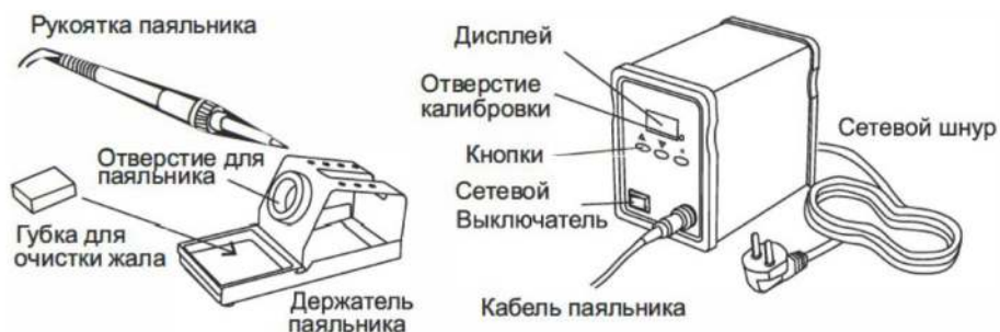
Рисунок 1 - Внешний вид и органы управления паяльной станции Verdo SE1202
