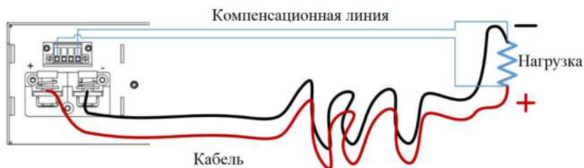
Рисунок 3 - Принципиальная схема подключения компенсации напряжения
