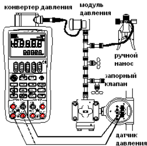
Рис. 15. Калибровка датчиков давления.
