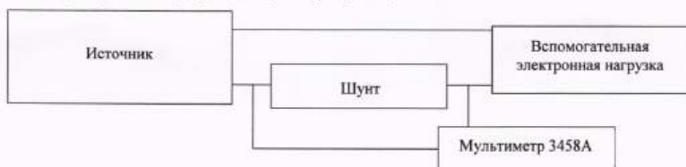
Рисунок 2 – Структурная схема определения абсолютной основной погрешности воспроизведений/измерений силы постоянного тока
