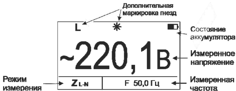
Рисунок 2.4. – Измерение напряжения и частоты
