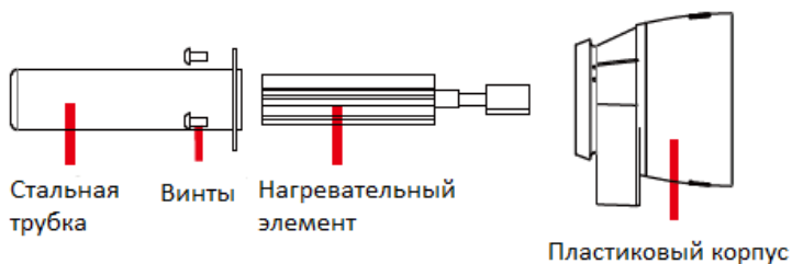
Рисунок 4 – Замена нагревательного элемента
