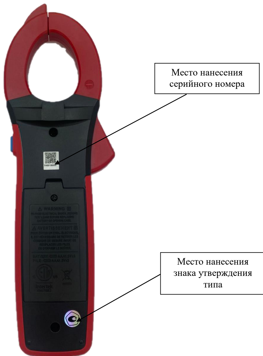
Рисунок 9 – Общий вид наклейки с указанием места нанесения знака утверждения типа, места нанесения серийного номера
