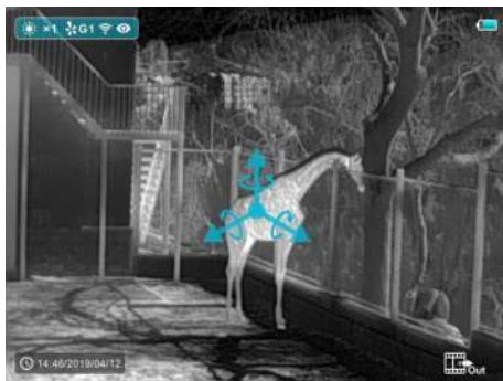
Рис. 11. Интерфейс режима калибровки компаса.
