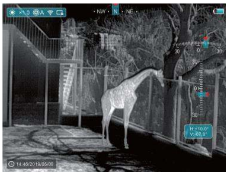
Рис. 10. Интерфейс режима угломера.
