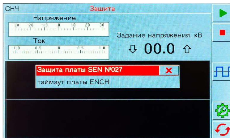
Рис. 13 неисправность «Нет связи с высоковольтным блоком»
