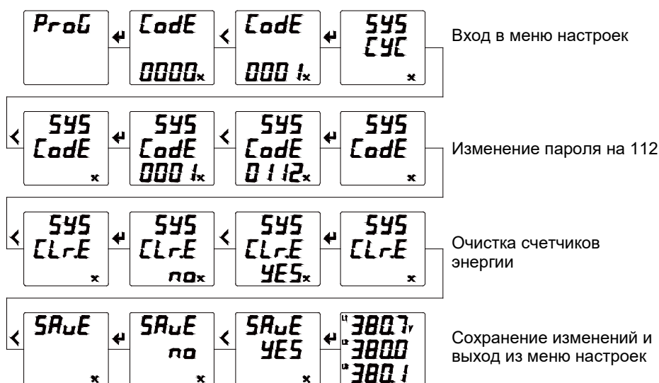
Рисунок 4.4.3.1 Установка системных параметров прибора с трехфазным экраном
