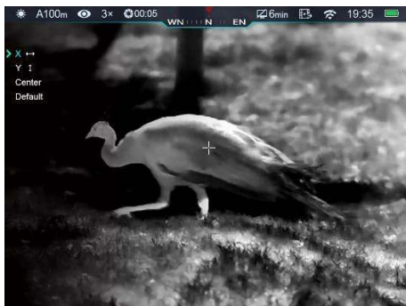
Рис. 6. Интерфейс калибровки дальномера.
