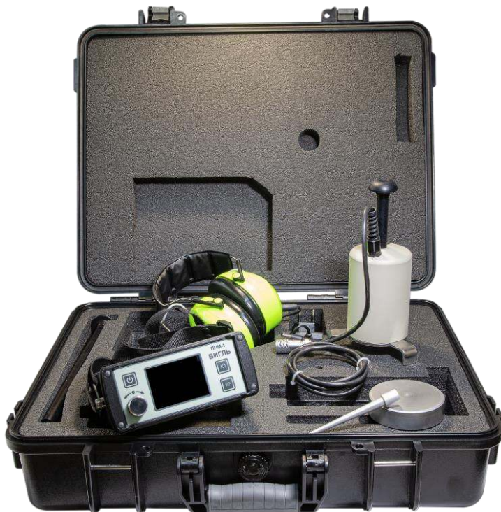
Рис.3 Трассофон, внешний вид основных устройств
