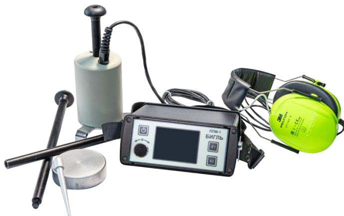
Рис.9 Акустический метод поиска неисправности в кабеле
