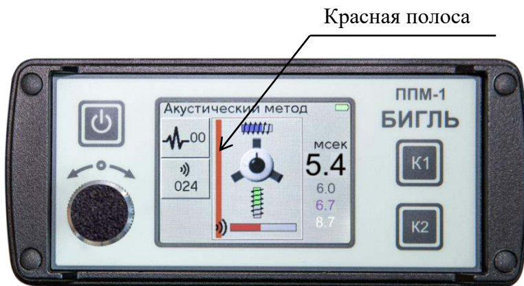
Рис. 12 Панель приемника ППМ-1 «Бигль» в акустическом режиме
