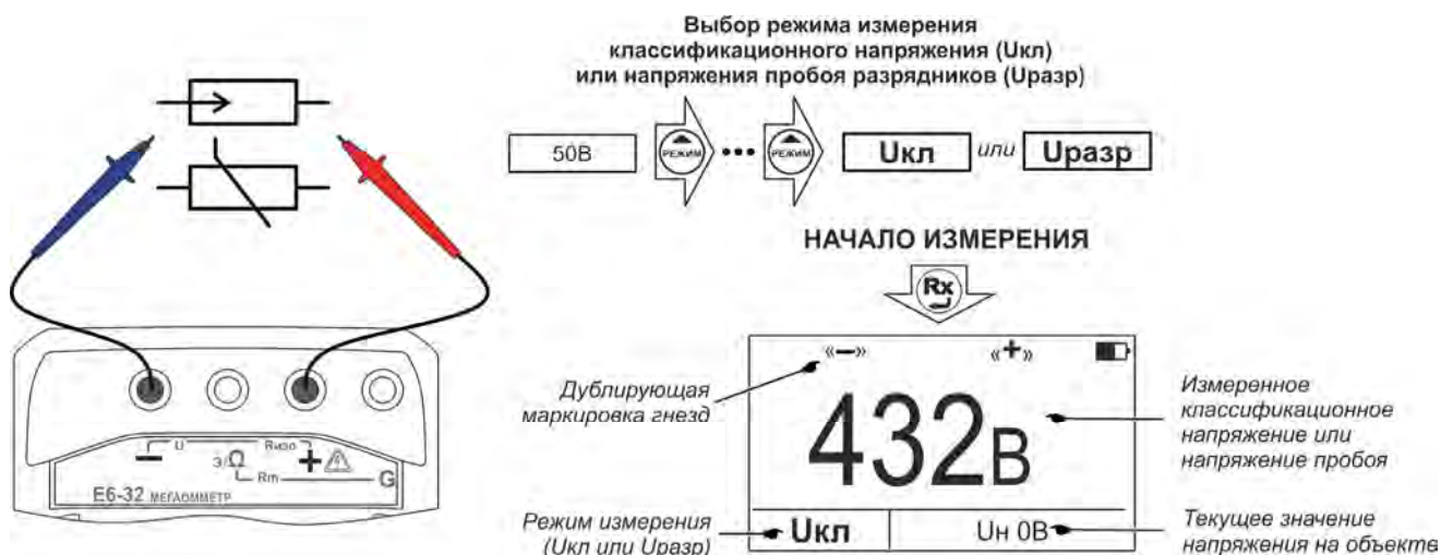
Рисунок 2.10 - Измерение классификационного напряжения или напряжения пробоя разрядников
