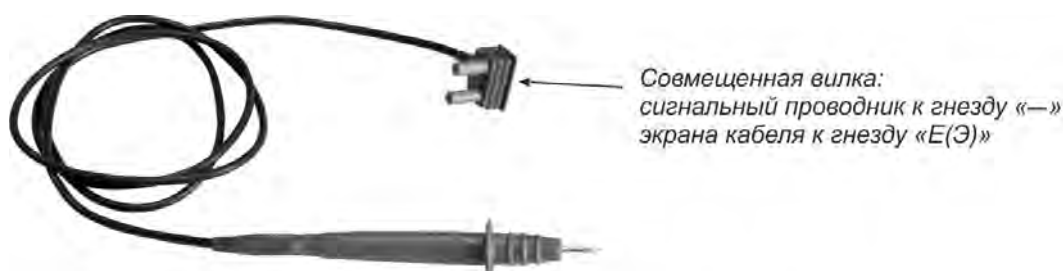
Рисунок 1.4 - Внешний вид экранированного измерительного кабеля РАПМ.685631.001
