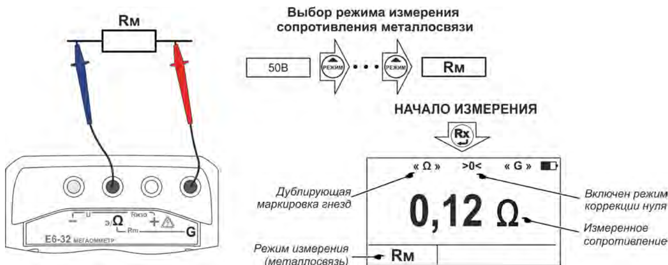
Рисунок 2.8 - Измерение сопротивления металlosвязи
