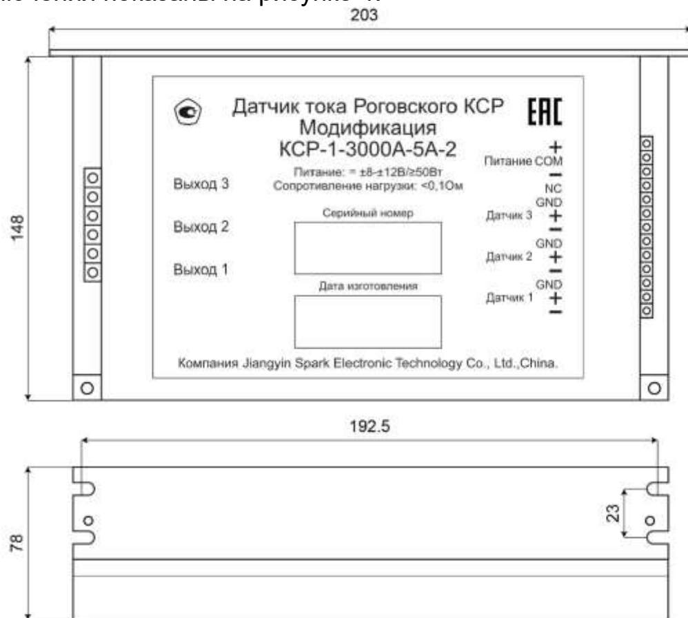
Рисунок 4 – Габаритные размеры интегратора для датчика КСР-1 с 3 каналами подключения
