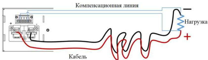
Рисунок 3 - Принципиальная схема подключения компенсации напряжения
