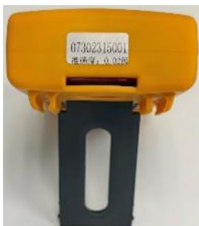
Рисунок 1 – Место нанесения серийного номера для VERDO CH3101/CH3102/CH3201/CH3202/CH3501/CH3502
