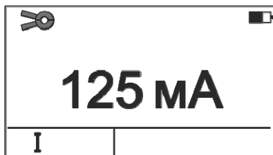
Рисунок 2.3.9.3 - Вид индикатора при измерении переменного тока
