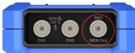
Рисунок 12 - Выходной разъем генератора сигналов
