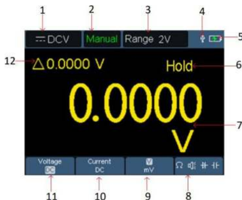
Рисунок 11 - Интерфейс дисплея в режиме мультиметра
