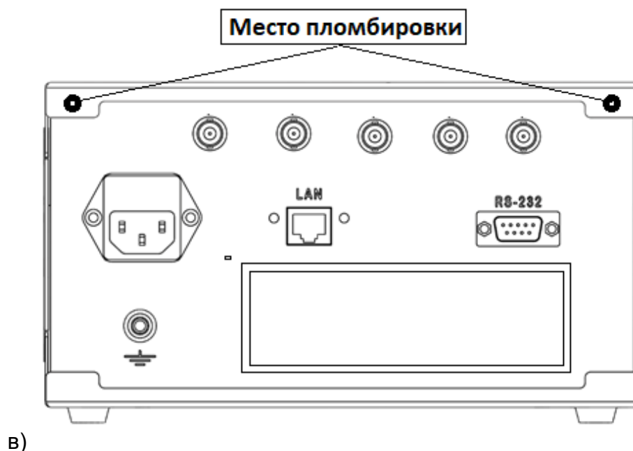
Рисунок. Схема пломбировки прибора ПрофКиП ЧЗ-99, ЧЗ-100, ЧЗ-101, ЧЗ-102.
