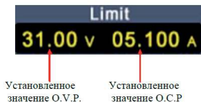
Рисунок 6 - Защита от перенапряжения/перегрузки по току
