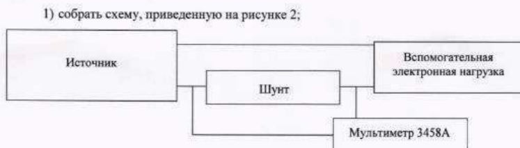
Рисунок 2 – Структурная схема определения абсолютной основной погрешности воспроизведений/измерений силы постоянного тока
