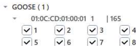
Рисунок 16. Выбор дискретных сигналов в GOOSE-сообщениях.
