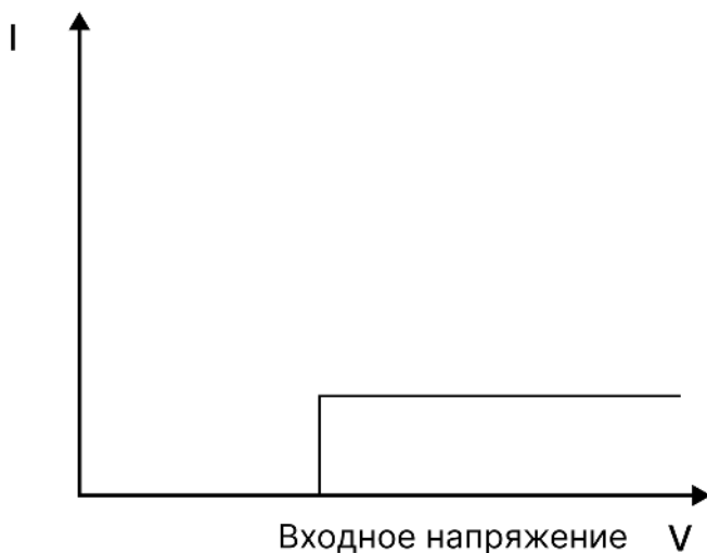
Рисунок 4.4 - Переключение режима постоянного тока в режим постоянного напряжения
