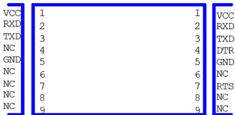
Рисунок 4.22 - М-131 Кабельный ПК со сдвигом уровня напряжения
