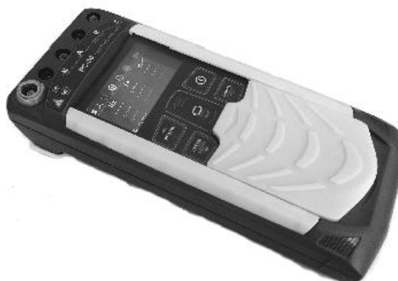
Рисунок 1 – Общий вид вольтамперфазометров РС-30
